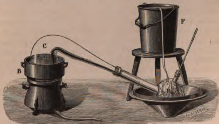
Fig. 127. — Préparation de l'acide nitrique monohydraté dans les laboratoires.
